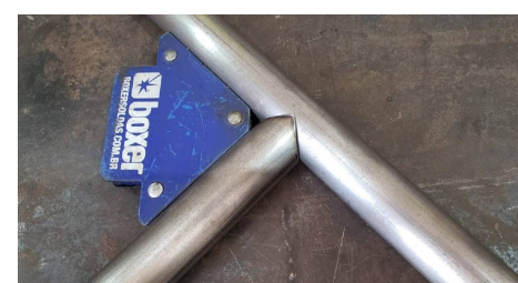
DETALHE TUBOS HORIZONTAIS E DIAGONAIS C/ EXTREMID C/ CORTE BOCA DE LOBO
