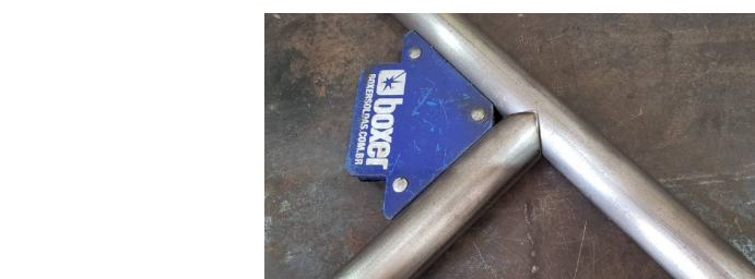
DETALHE TUBOS HORIZONTAIS E DIAGONAIS C/ EXTREMIDADES C/ CORTE BOCA DE LOBO
